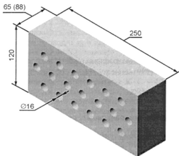
Рисунок A.1.1 - Кирпич формата 1(1,4) НФ с 19 цилиндрическими пустотами
