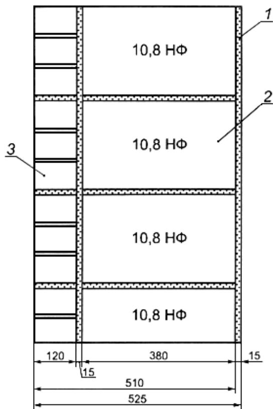
1 - штукатурка внутренняя:  $\delta = 15 \text{ мм}$ ,  $\gamma = 1600 \text{ кг}/\text{м}^3$ ,  $\lambda = 0,7 \text{ Вт}/(\text{м}\cdot\text{°C})$ ;
