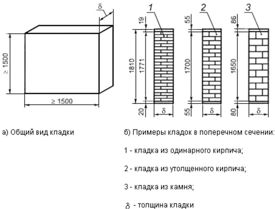
Рисунок 2 - Фрагмент кладки для определения теплопроводности
