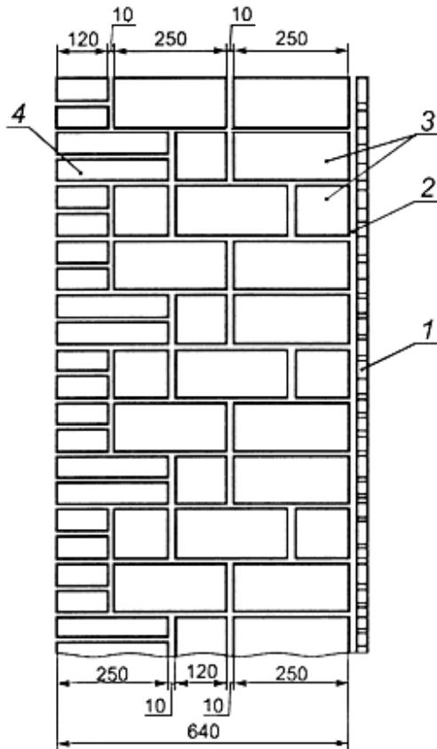
1 - сухая штукатурка из гипсовых обшивочных листов:  $\delta = 12 \text{ мм}$ ,  $\gamma = 800 \text{ кг}/\text{м}^3$ ,  $\lambda = 0,21 \text{ Вт}/(\text{м}\cdot\text{°C})$ ;
